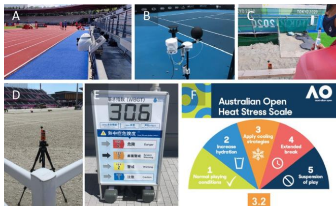
Figure 1 Surveillance et rapport des conditions environnementales. Panels A et B : dispositifs spécialement développés pour les Championnats du Monde d'Athlétisme et pour le tournoi de tennis de l'Open d'Australie, respectivement. Ce sont les solutions recommandées. Panels C et D : unités commercialement disponibles utilisées sur le terrain de jeu. Il n'est pas recommandé d'utiliser un appareil portable (panneau C) lorsque l'appareil a été placé à l'ombre entre les mesures car cela a entraîné une erreur de 2°C par rapport à l'appareil fixe. L'appareil doit être fixé sur un trépied avant l'événement car un certain temps d'équilibrage avec l'environnement est nécessaire pour assurer des mesures précises (panneau D). Panneau E : l'affichage de la température d (WBGT) et u globe-mouillé de la catégorie de risque préparé par le Comité d'organisation des Jeux Olympiques et Paralympiques de Tokyo. Cet affichage peut induire les athlètes en erreur car la plupart ne connaissent pas le score WBGT et peuvent le confondre avec la température de l'air. De plus, le codage des couleurs était différent de ce qui a été mis en place par diverses fédérations internationales. Panneau F : échelle de stress thermique codée en couleurs de 1 à 5 développée pour le tournoi de tennis de l'Open d'Australie par l'Université de Sydney. Elle fournit l'indice réel (valeur) et la recommandation correspondante. Cette méthode de feedback transmet un message clair aux athlètes et est recommandée.
